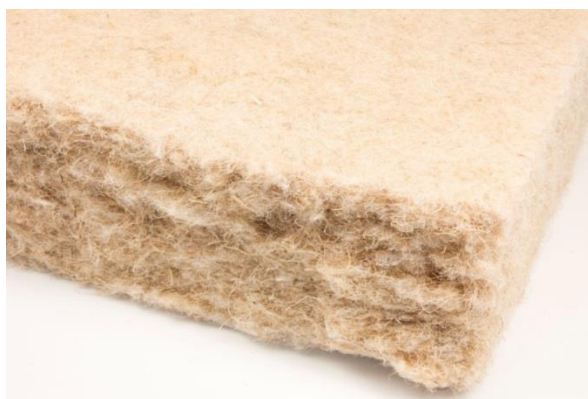
3 Сурет – Қарасора талшығынан жылуқшаулағыш
