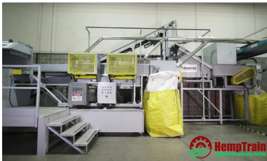
8 Сурет – Қарасораны діншеге және талшыққа бөлетін қондырғы
